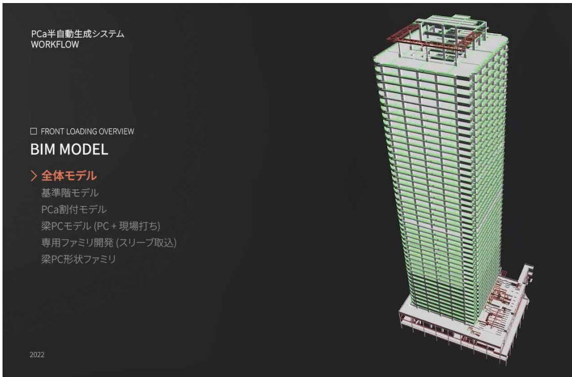
超高層集合住宅の構造モデルを利用し、PCa部材の製作図を作成
