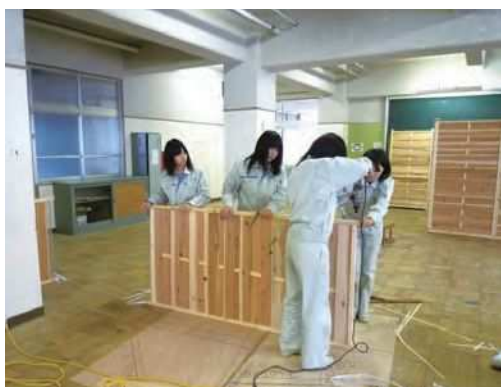
写真4 木製間仕切板製作
