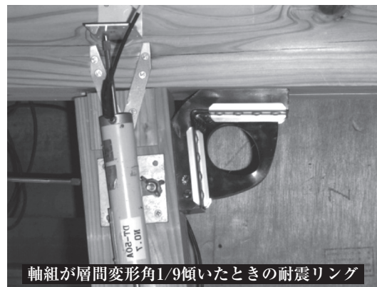
写真5 耐震リングR10の実大軸組実験
